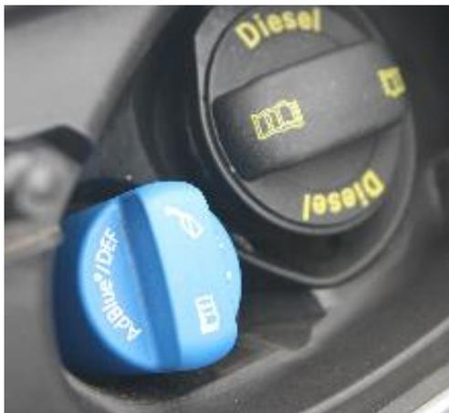
AdBlue é uma solução aquosa de ureia que atua sobre os gases de escape, como conversor catalítico, para reduzir as nocivas emissões de óxidos de azoto (NOx) gerados nos processos de combustão.
